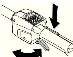
См. указания в разделе Запуск. Запустите машину на полную мощность. Отпустите переключатель и удостоверьтесь, что режущее оборудование останавливается и остается неподвижным.
